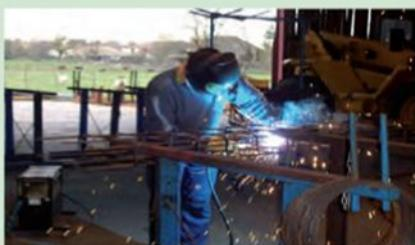
*Fabrication d'armatures acier pour construction en béton.*
